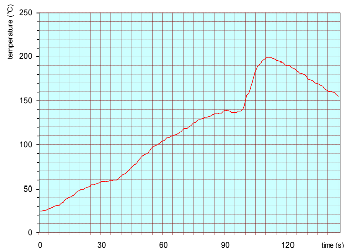
T° mesurée sur le dessus de la carte en process sans plomb.
